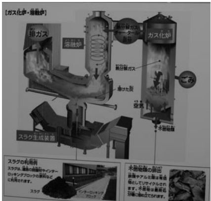
熱分解ガス化溶融炉
