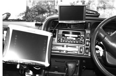
①情報センターから配車指示がタクシー端末に表示される。②タッチパネルで地図情報とも切替可能。③情報をセンターと送受信
